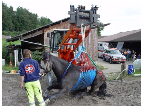
Anwendung des Tier- Bergungs- und Transportnetz TBTN
